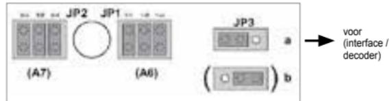
JP1 - brug geplaatst: 1-1 - Grootlicht, schakelbaar via AUX6
